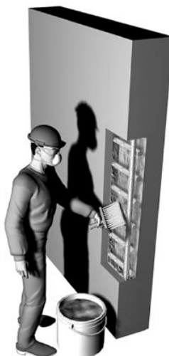
Figura 5 – Aplicação da proteção anticorrosiva nas armaduras
